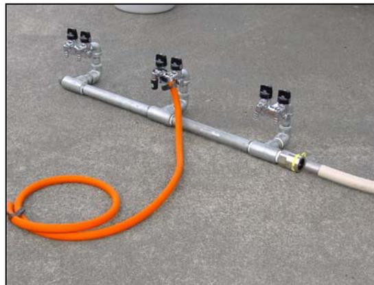
⑤ ガス栓(2口ヒューズガス栓)を配管に取付け、管の片側にフレキ用ワンタッチ継手を付ける。
